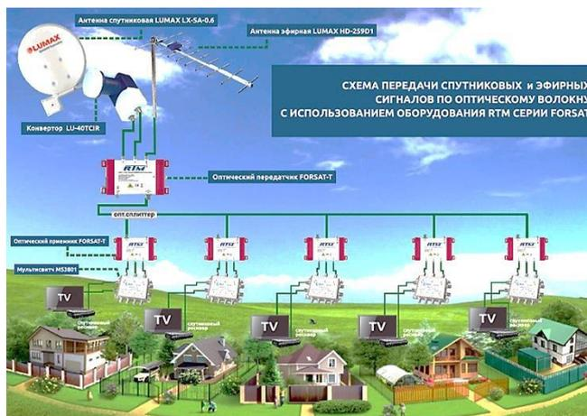
Одна из существенных особенностей оптической системы заключается в возможности передачи сигнала на очень большое, по сравнению с коаксиальной системой, расстояние без усиления. В классической схеме оптической системы должен присутствовать только источник оптического сигнала ( передатчик), оптический канал передачи ( оптический кабель) и приемник оптического сигнала ( индивидуальный или многопользовательский).
